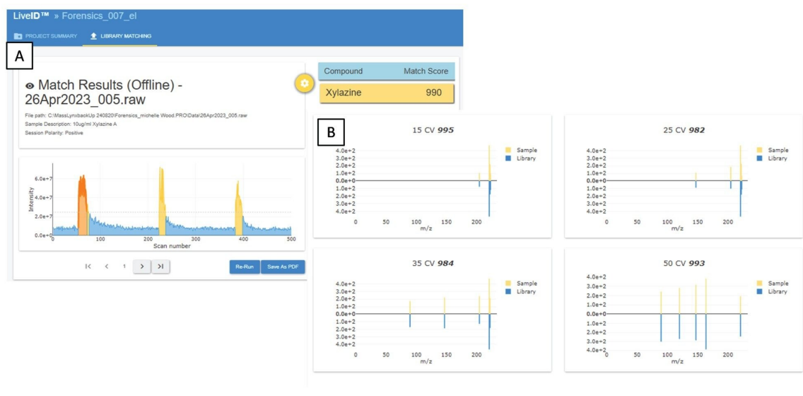
图2.赛拉嗪CRM (10 \mu\text{g}/\text{mL} )的LiveID分析。A图展示了赛拉嗪参比物质的三次重复“浸取和检测”分析结果，第一次三重样分析的匹配得分为990。图B展示了每种锥孔电压下所采集样品的谱图和新数据库匹配的详细信息。
