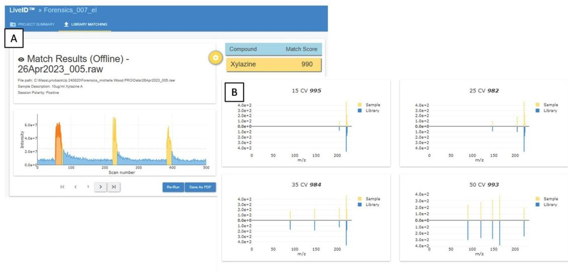
図 2.10  $\mu\text{g/mL}$  のキシラジン CRM の LiveID 分析。パネル A は、キシラジン標準物質の 3 回繰り返し「浸漬と検出」分析、および 3 回繰り返しの 1 回目で得られたマッチスコアが 990 であることを示しています。パネル B は、各コーン電圧で取り込んだサンプルと新規ライブラリーのスペクトルマッチの詳細を示しています。
