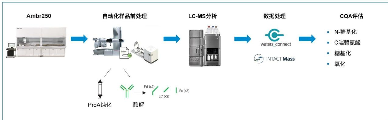
图1.mAb亚基MAM工作流程，使用Andrew+机器人平台进行自动化样品前处理（ProA纯化和FabRICATOR酶解），然后使用搭载waters\_connect信息学软件的BioAccord LC-MS系统采集和处理LC-MS数据。
