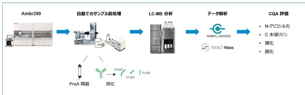
図 1. mAb サブユニット MAM ワークフロー。ProA 精製および FabRICATOR 消化に Andrew+ ロボットプラットフォームを使用した自動サンプル前処理、およびそれに続く waters\_connect インフォマティクスを使用した BioAccord LC-MS システムでの LC-MS データの取り込みおよび解析を含む。
