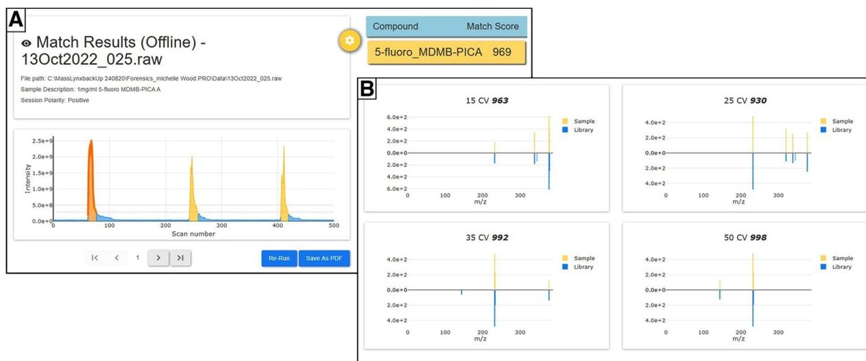
図 3.ピペッティングメソッドを用いて 50  $\mu\text{L}$  の 5-フルオロ *MDMB-PICA* をしみ込ませて作製したサンプルの *LiveID* 分析。パネル A に、しみ込ませたサンプルの「浸漬と検出」用紙片の 3 回繰り返しを示しており、最初の繰り返しで得られたマッチスコアが 969（最大 1,000）であることがわかります。パネル B にこのスペクトルマッチの詳細を示します。この同定プロセスでは、4 種類すべてのコーン電圧が加重平均（最も低いコーン電圧に最も大きく重み付けする）で使用されています。
