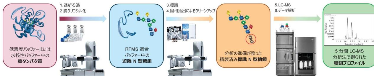
図 1. Andrew+ ピペッティングロボットを使用し、BioAccord LC-MS システムでの 5 分間 LC-MS メソッドを用いる迅速サンプル分析を使用する、低濃度または求核性バッファー中のサンプルからの標識 N 型糖鎖を自動前処理するワークフロー
