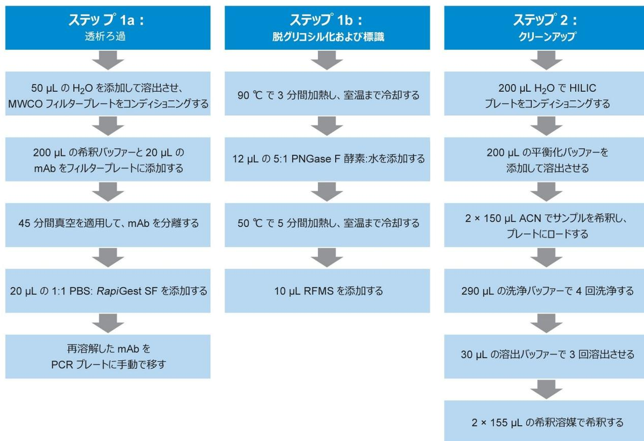
図 2. 低濃度または求核性バッファー中の *mAb* サンプルから標識 *N* 型糖鎖を迅速に調製するための自動透析ろ過 GlycoWorks RapiFluor-MS プロトコルの概要を示すフローダイヤグラム
