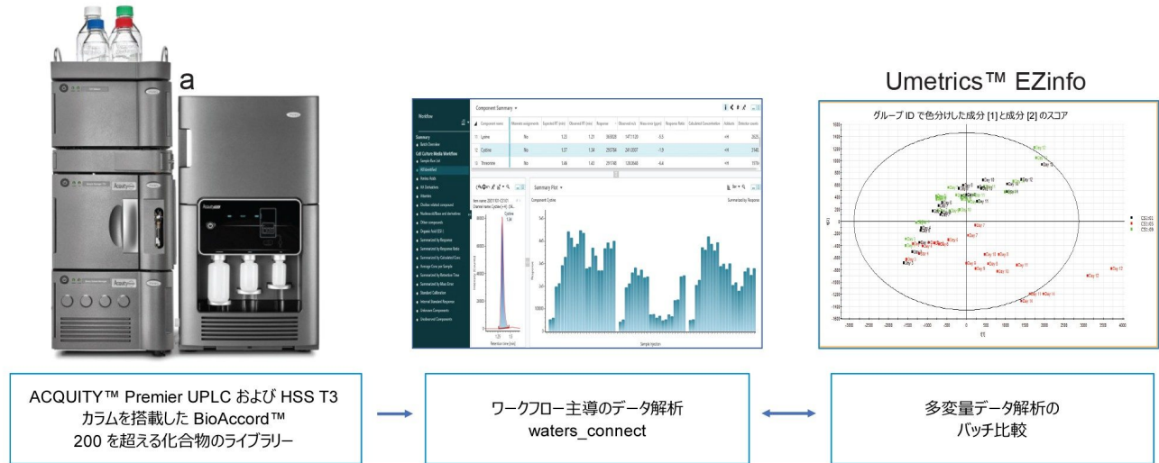
スキーム 1.細胞培養培地の分析に用いる BioAccord システム/waters_connect™ に基づくワークフローの概略図
