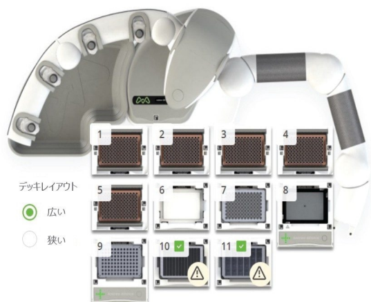
図 2. 最大 48 サンプルの自動化したプロテイン A 精製およびサブユニット分析が可能な Andrew+ ドミノおよびコネクテッドデバイスの構成
