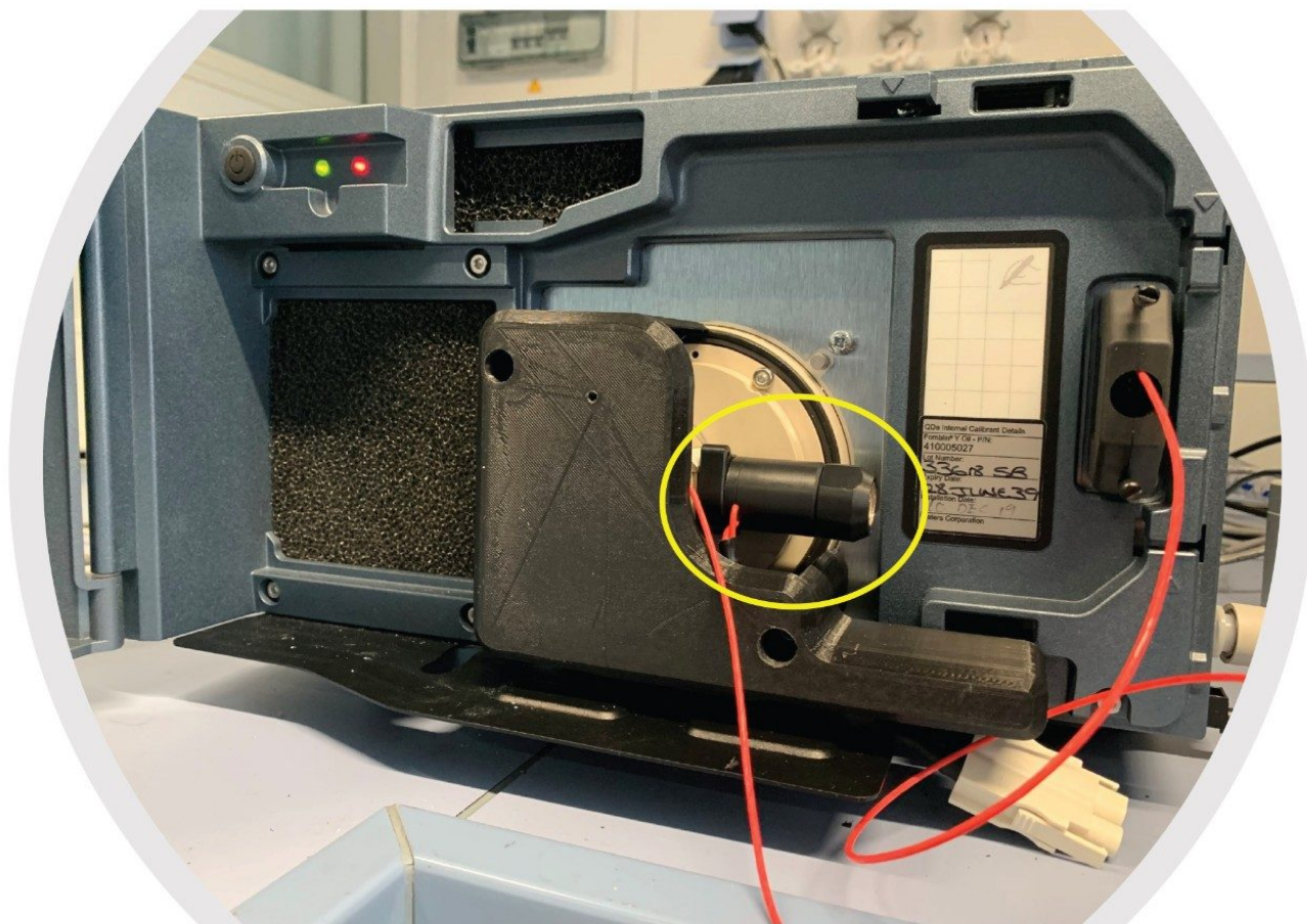
図 1. Waters ACQUITY QDa 検出器に接続した Plasmion SICRIT
