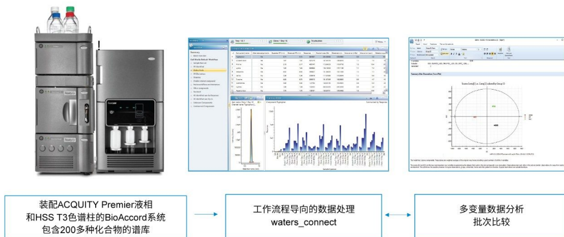
图示1.基于BioAccord/ waters_connect 的培养基分析工作流程示意图（摘自沃特世应用纪要 3 ）。
