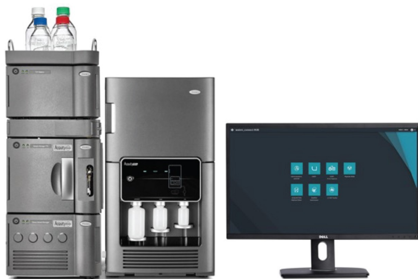
図 1. ACQUITY Premier を搭載した BioAccord システム。ACQUITY Premier テクノロジーには、MaxPeak High Performance Surfaces (HPS) を採用した流路、フリット、カラムが含まれ、分析種の金属表面への吸着が低減します。
