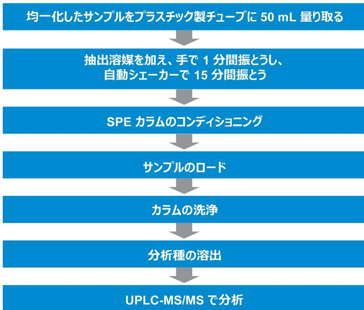
図 1. トラップ・溶出モードの SPE による鶏肉中の禁止動物用医薬品の定量のためのサンプル前処理のワークフロー
