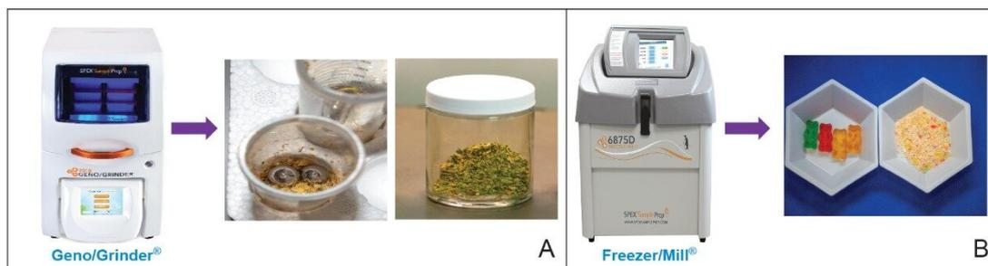
图1.利用Geno/Grinder®对固体材料进行溶剂提取（A图）。不锈钢珠有利于粉碎，可用于QuEChERS提取过程的振摇步骤。利用Freezer/Mill®粉碎软糖和粘性材料（B图）。
