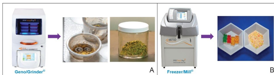
図 1. 固形物の溶媒抽出に用いた Geno/Grinder ® (パネル A)。ステンレス製ボールは粉碎を容易にし、QuEChERS 抽出での振とうにも使用することができます。Freezer/Mill ® を用いてグミや粘着性の材質を粉末にしました (パネル B)。
