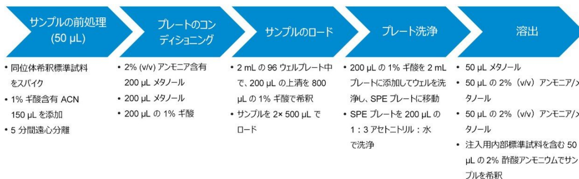
図 1. Oasis WAX 96 ウェル μElution プレートを使用したヒト血清中の PFAS の固相抽出プロトコル
