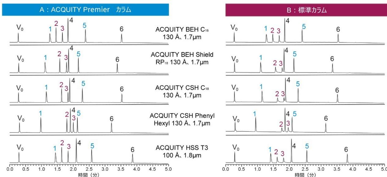
図 2. MaxPeak Premier カラムと標準カラムを使用して得られた分離の比較。ピーク同定: v<sub>0</sub>: チオ尿素、1: メブプロロール、2: ヒドロコルチゾンリン酸塩、3: デキサメタゾンリン酸、4: プレドニゾン、5: アミトリプチリン、6: ジプロピルフタル酸。
