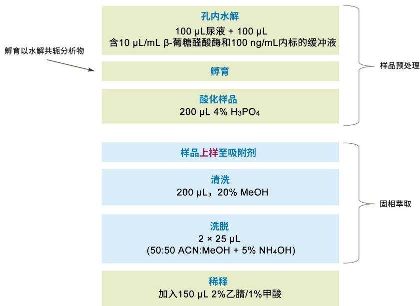
图1.使用Oasis MCX \mu Elution板分析综合性药物组时所用萃取方法的详细信息。酶水解和样品预处理均在萃取板的孔内进行，尽可能减少了转移步骤。免除了活化和平衡步骤，并且用一步清洗代替两步清洗，极大地简化了操作流程。
